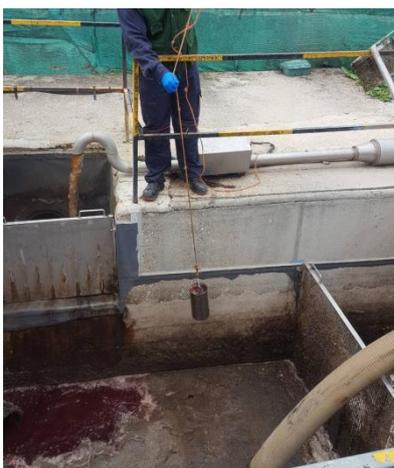
Figura 2. Toma de muestra para la caracterización de las aguas residuales
