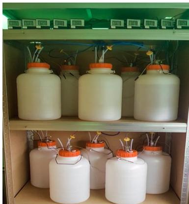
Figura 3. Ensayos de crecimiento de microalgas en reactores de 10 L
